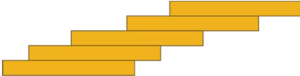
L'objectif est de construire le pont le plus long en kapla avec une seule arche et avec un seul kapla par niveau.
