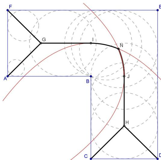
Figure 10 : la ligne de crête (en noire) pour la table en forme de L
