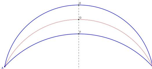
Figure 18 : arc de cercle passant par trois points A, G et B à égale distance des deux arcs de cercles de la lune
