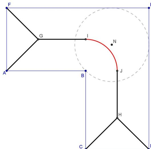
Figure 9 : l'arc de cercle en rouge ne passe pas par N, donc ce n'est pas la ligne de crête
