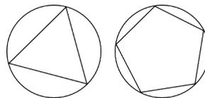
Quel polygone choisir ? Il doit être le plus « rentable » : on doit pouvoir couvrir un maximum de surface avec un minimum d'antennes. *Comment calculer un indice de rentabilité ?*
