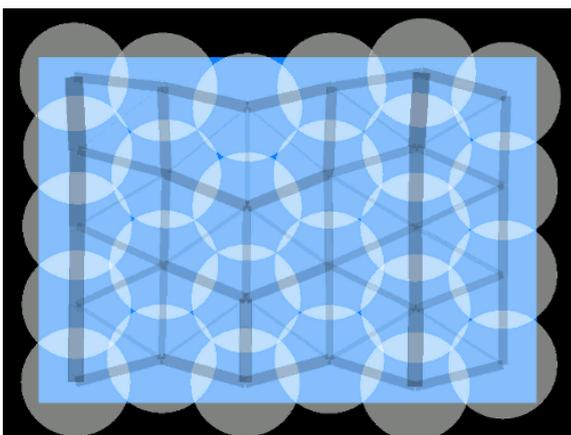
L'épaisseur des traits gris foncé montre l'intensité des forces de répulsion des antennes
