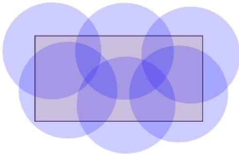
Un exemple d'agencement d'antennes sur une ville rectangulaire. Ce n'est pas forcément une configuration optimale !
