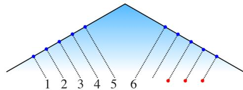
Entre les positions 5 et 6, le point  $P$  change brusquement de segment. Cela se traduit par un vecteur-force qui change subitement de direction, provoquant un effet de « spasme » pour l'antenne. Ce spasme est d'autant plus remarquable si des forces externes la poussent à rester dans cette zone de transition : l'antenne bascule alors incessamment entre deux positions successives, ce qui nuit à la stabilité de la configuration, ainsi qu'au calcul des forces des antennes adjacentes.
