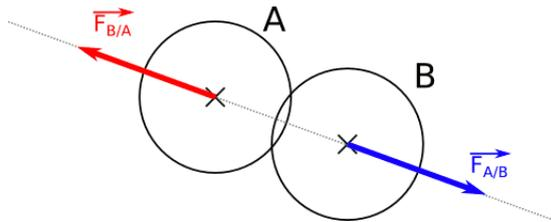
Dans notre modèle, la norme [et le déplacement] est choisie proportionnelle à  $1 - \frac{O_A O_B}{2R}$  ( $2R$  étant la distance maximale entre les centres de deux antennes sécantes).
