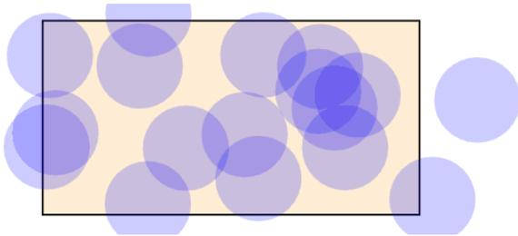
On remarque que cette solution est loin d'être optimale : le territoire n'est pas couvert entièrement, malgré un nombre d'antennes a priori suffisant ! Trop d'antennes se recoupent inutilement. Trop d'antennes dépassent de la ville.
