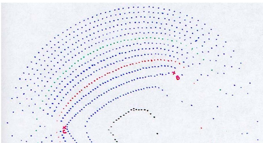
Tracé de l'ovoïde pour des points A, B et C disposés en triangle
