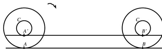
A chaque instant la petite roue roule sur le segment [A'B'], on va revenir en B avec le point A' qui va lui à nouveau se retrouver ici au point le plus bas.
