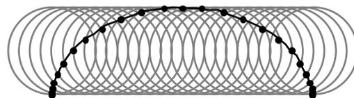
Quand la roue a fait un tour complet, le point original est revenu au sol, on a donc des *arches* de cycloïde qui se répètent, ce qui donne une courbe, avec des tangentes verticales.
