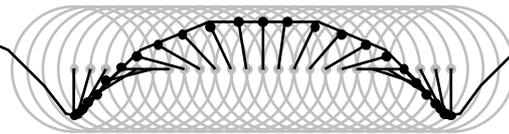
On peut aussi imaginer qu'on fixe un point extérieur, qu'on cherche le mouvement d'un point qu'on imagine lié au cercle mais extérieur au cercle : alors on obtient une cycloïde allongée.
