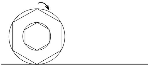
Il va y avoir un trou avant que le côté suivant ne vienne s'appliquer etc. Donc je vais avoir des trous.
