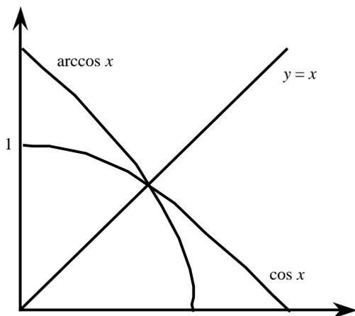
On constate que l'intégrale entre 0 et 1 de la fonction arccos correspond à l'aire comprise entre la courbe d'équation  $y = \arccos x$ , l'axe des abscisses et celui des ordonnées. Par symétrie par rapport à la première bissectrice, on peut plus simplement calculer l'aire comprise entre la courbe d'équation  $y = \cos x$ , l'axe des abscisses et celui des ordonnées.
