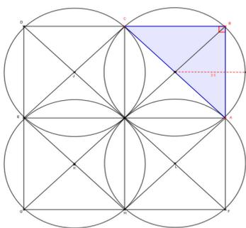
Nous séparons notre pièce de 10 mètres de côté en quatre carrés identiques. Les centres des détecteurs sont les points d'intersection des diagonales et les diagonales sont des diamètres.
