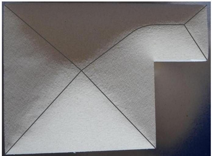
Figures 12a-12b: ligne de crête dans le cas de l'assemblage de deux rectangles de tailles différentes et expérience correspondante.
