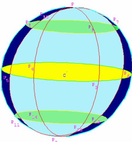
Ensuite, on a créé le parallèle sud symétrique au parallèle nord par rapport à C (le centre de la sphère). On obtient alors P<sub>11</sub>, P<sub>12</sub>, P<sub>13</sub> & P<sub>14</sub> comme points
